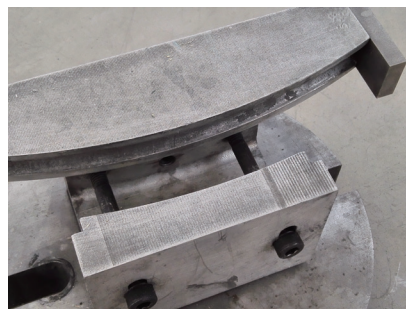
图11 钛合金叶片夹具
